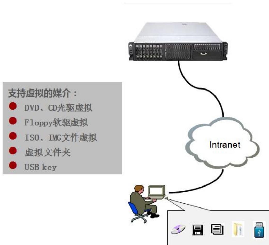
图 3-25 虚拟媒体实现原理
