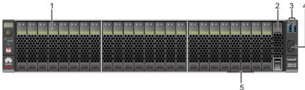
图 2-4 24x2.5 SAS/SATA 硬盘直通配置前面板组件
