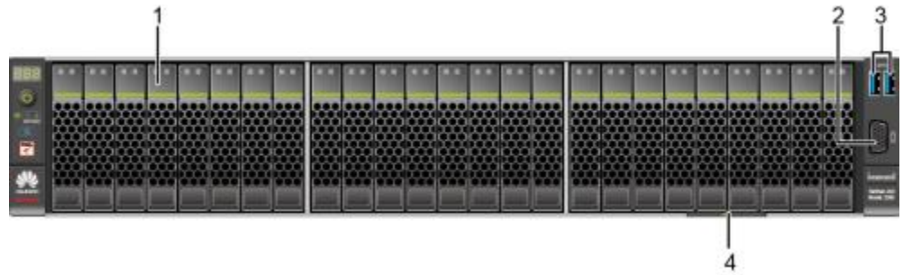
图 2-2 25x2.5 英寸硬盘配置前面板组件
