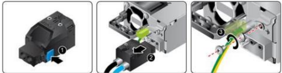
图 5-28 拔出电源线缆(2000W 电源模块)
