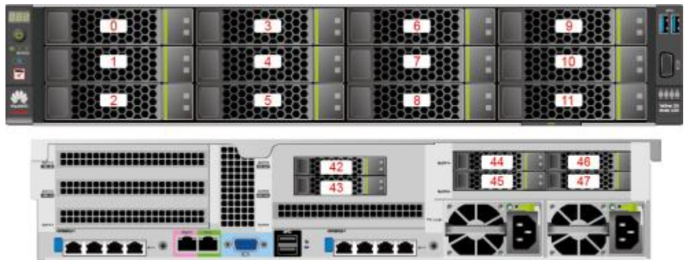
图 2-16 12x3.5 英寸硬盘直通配置
