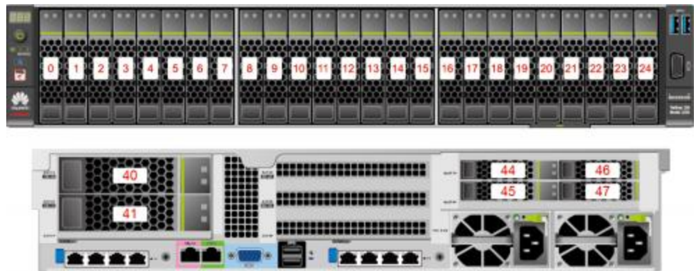
图 2-18 25x2.5 英寸硬盘 EXP 配置硬盘编号
