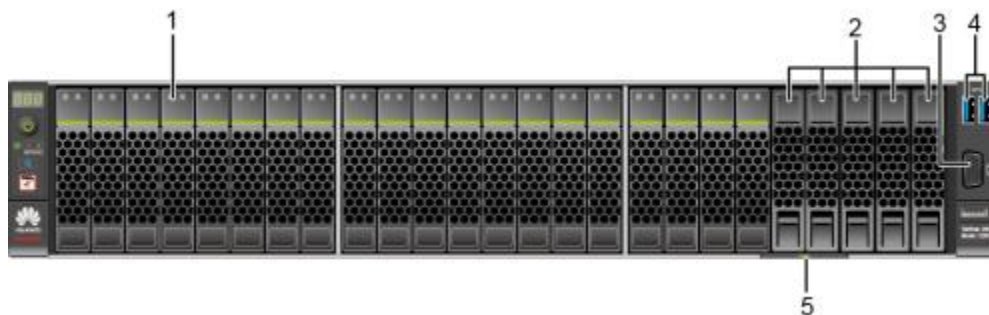
图 2-3 8x2.5 SAS/SATA+12x2.5 NVMe 硬盘配置前面板组件
