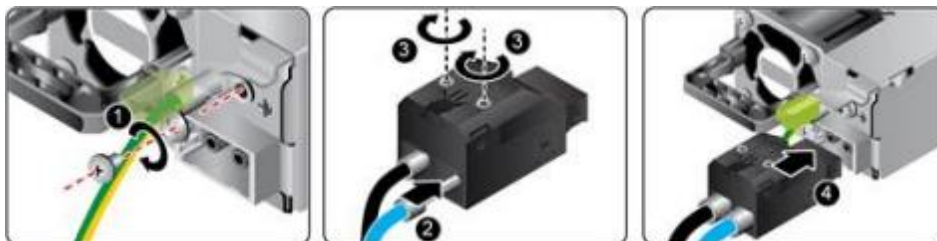
图 5-33 连接电源线缆(2000W 电源模块)
