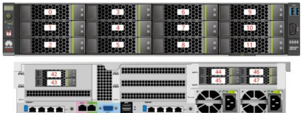
图 2-17 12x3.5 英寸硬盘 RAID 直通配置编号
